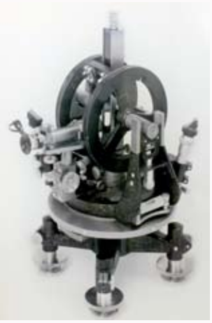
田中館愛橋が考案した当時世界一の精度を誇った電磁方位計（田中館愛橋記念科学館提供）
